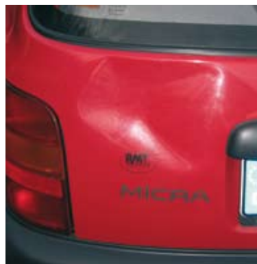
Schaden durch einen Fußball
